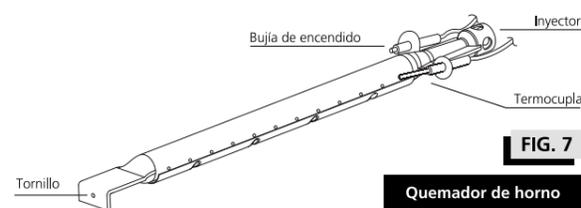
Una vez realizado el cambio de inyectores, proceda a la regulación de los "mínimos" de las válvulas de hornallas y del horno.
