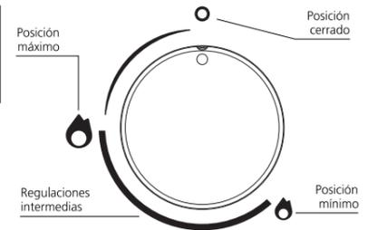
**FIG. 9** Perillas de hornallas y horno
