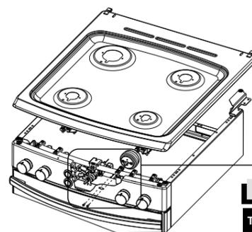
**FIG. 9** Termostato
