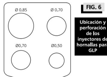
**FIG. 6** Ubicación y perforación de los inyectores de hornallas para GLP
