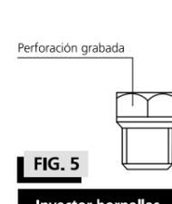
**FIG. 5** Inyector hornallas y horno
