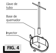
**FIG. 4** Cambio de inyector hornalla
