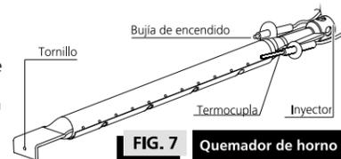
**FIG. 7** Quemador de horno
