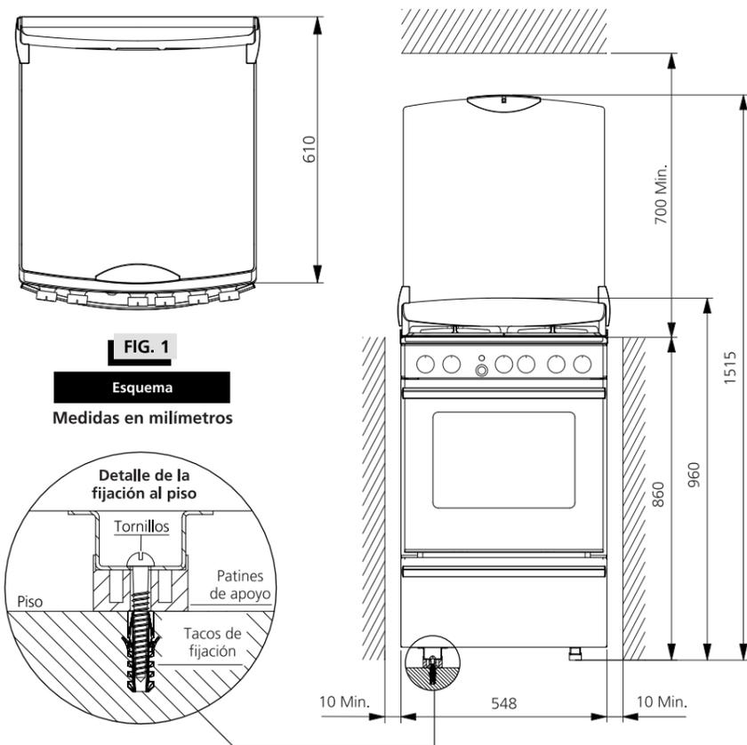
• Antes de la instalación, asegurarse de que las condiciones de distribución local (naturaleza y presión del gas) y el reglaje del artefacto son compatibles.
