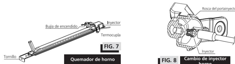
Una vez realizado el cambio de inyectores, proceda a la regulación de los "mínimos" de las válvulas de hornallas y del horno.
