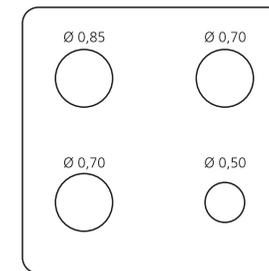
Ubicación y perforación de los inyectores de hornallas para GLP
