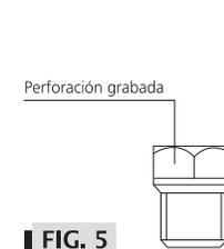
Inyector hornallas y horno
